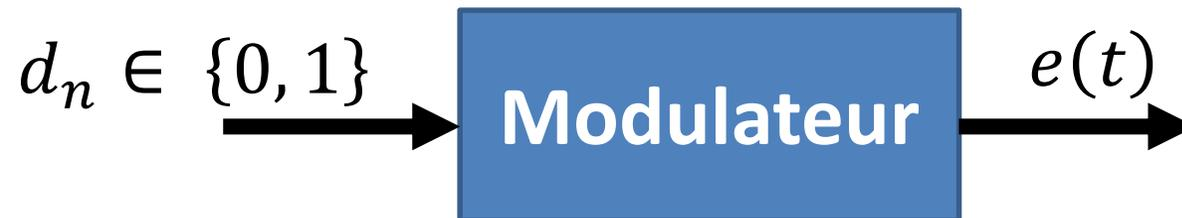
**La modulation a pour rôle d'adapter le spectre du signal au canal (milieu physique) sur lequel il sera émis.**
