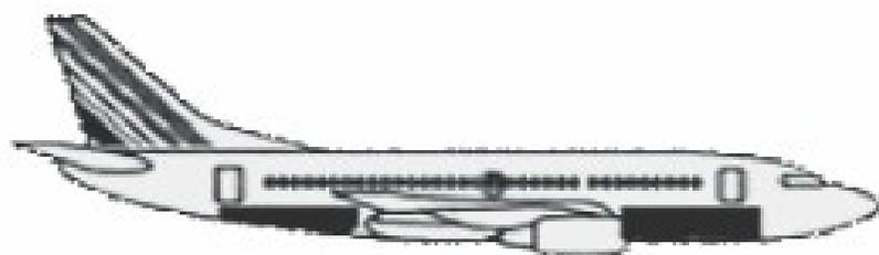
Le Boeing 737 est un biréacteur moyen-courrier à fuselage étroit et qui comporte deux soutes vrac ventrales. Le rayon d'action est de 2700 à 4650 km, selon les sous-types.
