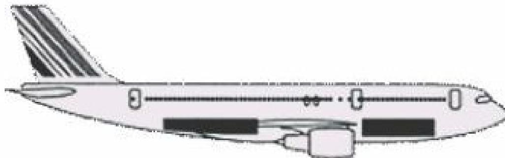
Le Boeing 767 est un biréacteur long courrier, de rayon d'action de 10.900 km. Les soutes avant et arrière sont palettisées, le compartiment avant comprenant une porte cargo large. Pas de possibilité de palettes avec débords. Le compartiment vrac est situé à l'arrière de l'appareil.
