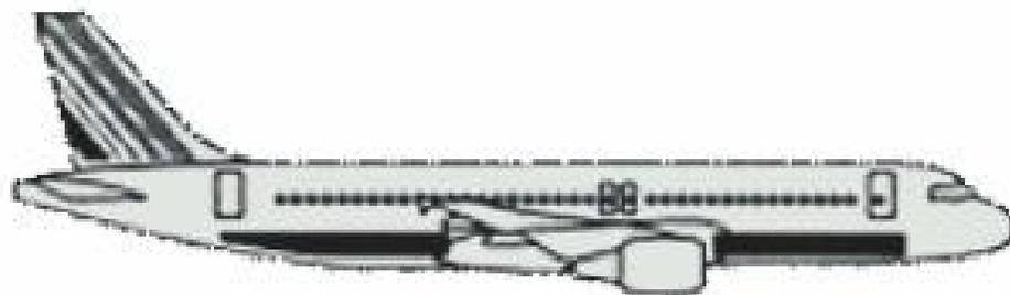
L'Airbus 320/321 sont des bi-réacteurs moyen-courrier, à rayon d'action de 3500 à 5600 km. Avions à fuselages étroits, ils sont conteneurisés et admettent le chargement, sur une file, de palettes de même base que sur les avions gros porteurs, mais à hauteur réduite. A 319 est configuré en soute vrac seulement.
