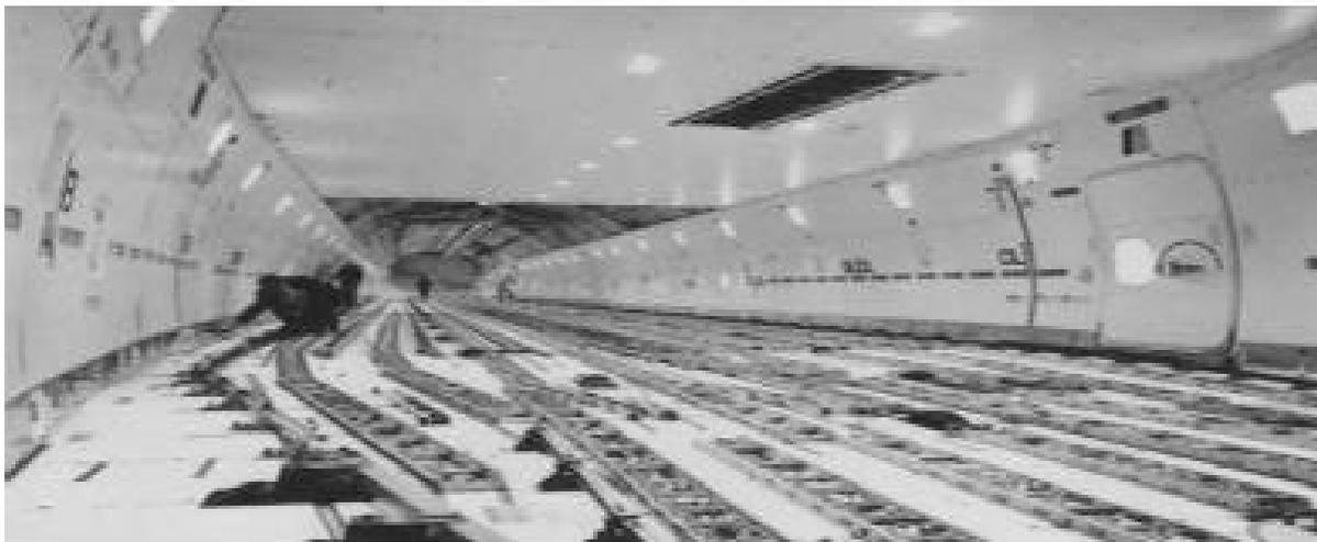
Ⓑ vue intérieure - rails et rouleaux équipant le plancher
