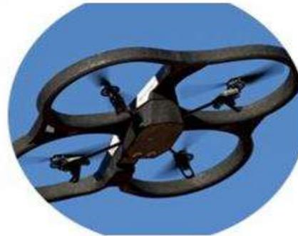
**Iron** est capable de corriger sa trajectoire, de se **stabiliser** en restant en vol stationnaire. Il **exécute** aussi en temps réel les commandes envoyées par la radiocommande.
